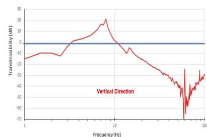
MagLevit Hybrid は、メンテナンスフリーの磁気浮上式モジュールにスプリング機構を追加したことで床面からの振動を以前よりもさらに効率よく遮断できるようになりました。今回の改良に伴い、高さ調整用ノブは全モデルで接地面より下となり、上に載せる顕微鏡の操作が行いやすくなりました。
