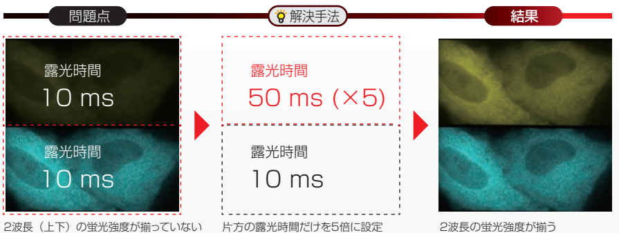
2波長 (上下) の蛍光強度が揃っていない 片方の露光時間だけを5倍に設定 2波長の蛍光強度が揃う
